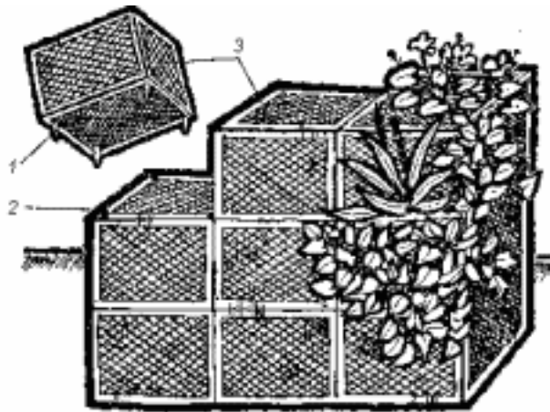
Рис. 8. Цветочная стена из отдельных элементов: 1 – шипы; 2 – пазы; 3 – одинаковые "строительные элементы".
